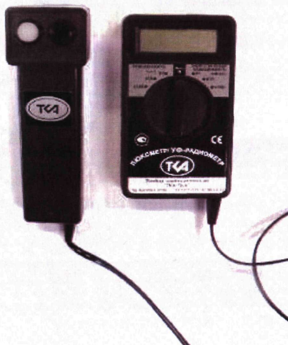
Рис. 7. Комбинированный люксметр + УФ-радиометр «ТКА-ПКМ» (модель 06)
